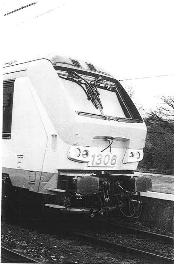
De locomotieven reeks 13 hebben een ergonomisch front gekregen. Op de foto is duidelijk te zien dat de voorruit enigszins "verzonken" zijn gemonteerd. Dit zou tevens verblinding door de zon in belangrijke mate beperken wat het comfort van de bestuurder ten goede komt. Om de luchtweerstand te beperken zijn de lampenhouders in de kast ingebouwd en werden de verbindingkabels weggeborgen in een afsluitbaar luikje. Foto : Jan Mahieu.
