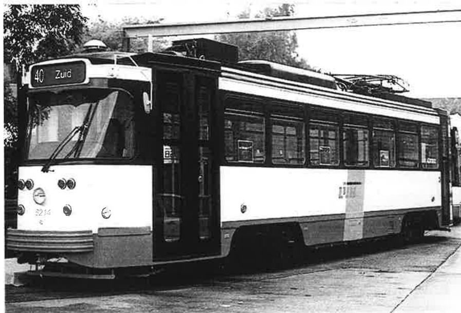
De 6214 in de stelplaats van Gentbrugge op 2 oktober 1999. Duidelijk te zien zijn de nieuwe deuren en de apparatuur op het dak. Foto : Luc Couscheir.
